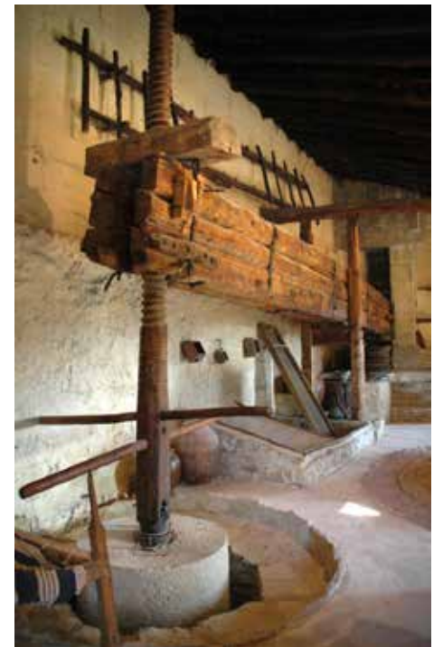
Fig. 6: Prensa de viga de la almazara bajoaragonesa de Jaganta, con la libra y la caracola en primer plano, las guiaderas y la mediana en el centro y la capilla y el torreón de contrapeso al fondo. Foto: Alberto Bayod.
