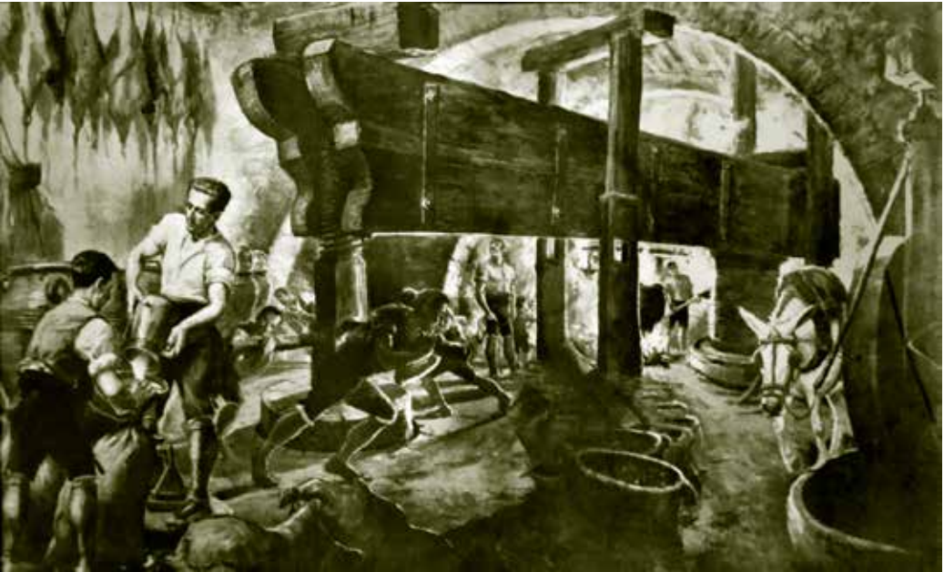
Fig. 1: Grabado que refleja las actividades realizadas en los antiguos molinos de aceite bajoaragoneses dotados de prensas de libra (moltura y prensado de la oliva, escaldado de la pasta, depuración y envasado del aceite, etc.) y el tórrido ambiente creado en su interior. Publicado por Nuova Pieralisi.
