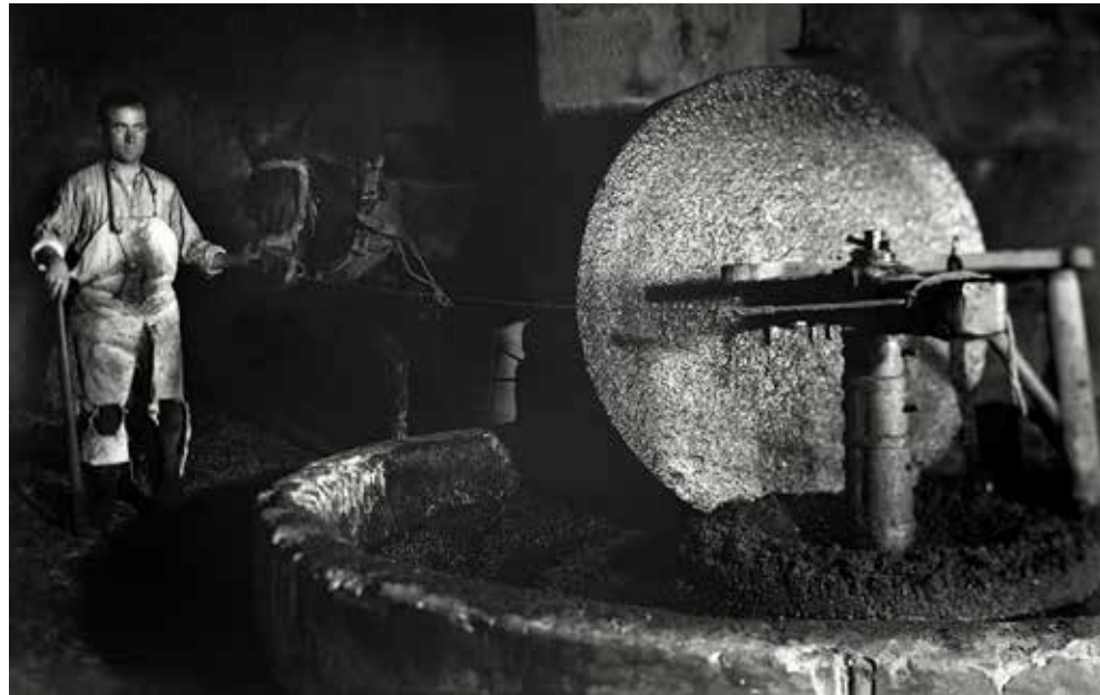
Fig. 4: Operario del antiguo molino oleario de prensa de viga y libra de Piracés (Huesca) dirigiendo el giro de la caballería que movía el rollo durante el proceso de moltura de la oliva (c. 1920-1936). Foto: Ricardo Compairé Escartín. Fototeca de la Diputación de Huesca.
