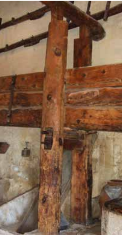
Fig. 4: Guiaderas, almazara de Jaganta. Foto: J. A. Benavente
