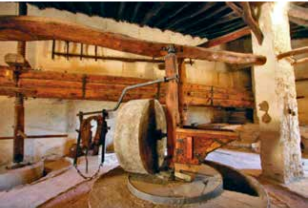
Fig. 6: Molino con rulo de piedra de la almazara de Jaganta. Foto: J. A. Benavente.
