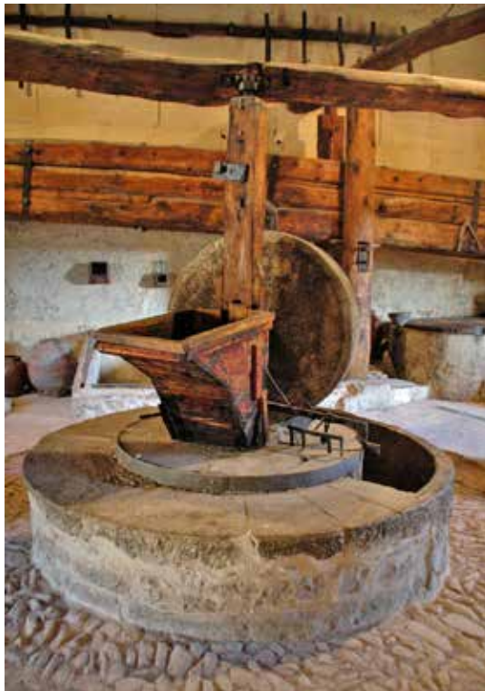
Fig. 5: Rollo de moltura, tolva de madera para depositar las olivas y çaffa o muela yacente, dotada de sotana y escudilla, del molino de aceite de Jaganta, probablemente muy similar a los seis que llegó a tener la antigua almazara de Castelserás. Foto: Alberto Bayod.
