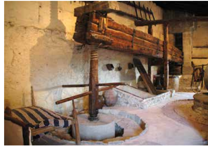
Fig. 34: La excepcional prensa de viga y libra que todavía podemos contemplar hoy en día en el molino de aceite de Jaganta es el fiel reflejo de los más de 300 ingenios o artefactos de este tipo que poblaron las almazaras bajoaragonesas (233 en la zona turolense y 72 en la zaragozana) con 212 prensas en molinos comunales y 93 en particulares. Foto: Alberto Bayod.
