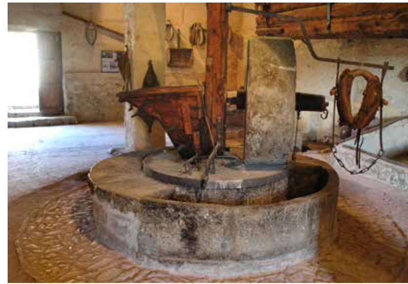
Fig. 3: Rollo para moler las olivas, tolva de madera para depositarlas y çaffa o muela yacente, dotada de sotana y escudilla, del molino de aceite de Jaganta, pedanía de Las Parras de Castellote. Foto: Alberto Bayod.
