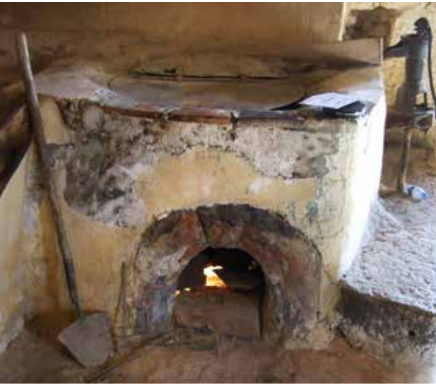
Fig. 2: Caldera para calentar agua, almazara de Jaganta. Foto: J. A. Benavente.
