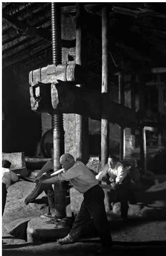
Fig. 7: Evocadora imagen de cuatro de los operarios del molino oleario de Piracés (Huesca) haciendo girar la caracola que activaba el funcionamiento de la prensa de viga y permitía levantar la pesada libra para prensar el pie formado por capas llenas de pasta de oliva, previamente molida (c. 1920-1936). Foto: Ricardo Compañé Escartín. Fototeca de la Diputación de Huesca.
