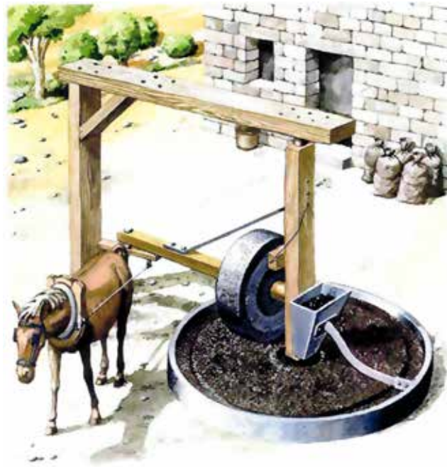
Fig. 2: Dibujo de un rollo de moltura girando sobre la muela yacente y deshaciendo la oliva. La fuerza motriz habitual, denominada como “tracción de sangre”, era una caballería. Publicado por Nuova Pieralisi.
