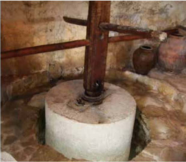
Fig. 5: Libra, quintal o contrapeso de prensa en la almazara de Jaganta. Foto: J. A. Benavente.
