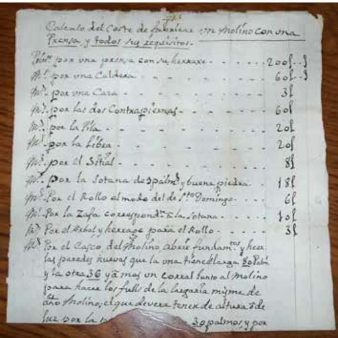
Fig. 6a y 6b: Detallada valoración del coste de la construcción de una almazara de una sola prensa para el convento de religiosas clarisas de Valdealgorfa (1773). El importe total ascendía a 765 libras jaquesas y el documento permite conocer minuciosamente todos los elementos necesarios para la fábrica y el funcionamiento de un molino oleario. Archivo Casa Ejerieque (Valdealgorfa), cedido por Carlos Estevan.
