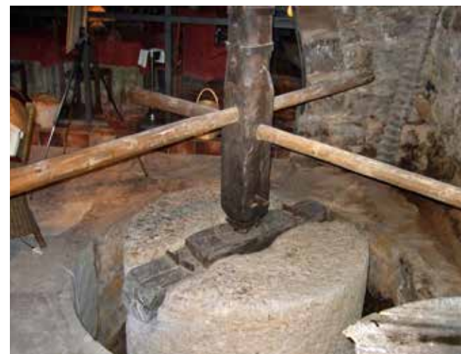
Fig. 19: Contrapeso o libra de la prensa de viga del Molí de L'Hereu de Ráfales. Foto: J. A. Benavente.
